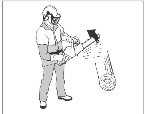
Un rebond ne peut se produire que lorsque la zone de rebond du guide-chaîne entre en contact avec un objet. Ne laissez la zone de rebond entrer en contact avec aucun objet.
